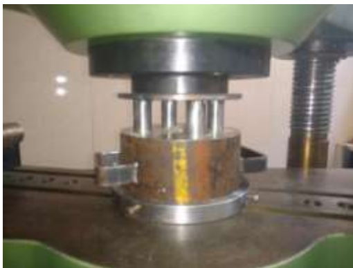
Fig. 1. Multi briquetting die loaded in UTM
